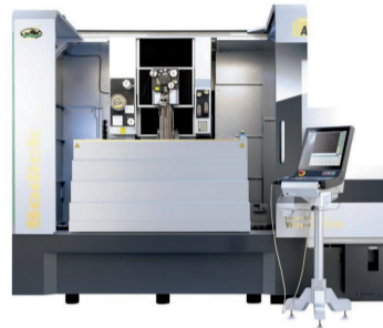
Sopra le foto delle elettroerosioni Sodick scelte da meccanica tecnica la AQ327L 370x270x 250 e la Sodick ALC800G 800x600 500 con la zeta di 800
